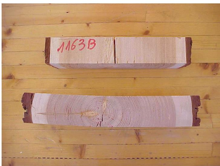
Détermination des largeurs de cernes et de la texture sur rondelles sur deux rayons
