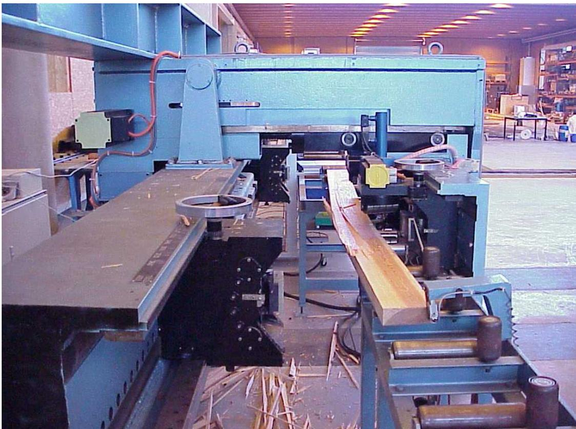
*Banc de flexion du CTBA de Bordeaux où les avivés sont sollicités à chant, dans le cas d'une utilisation structurelle, afin de déterminer la contrainte à la rupture et le module d'élasticité*
