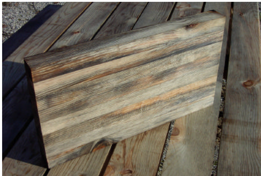
Panneaux contrecollés en Pin d'Alep type BMR (Bois Massif Reconstitué) ayant fait l'objet d'un traitement à l'huile
