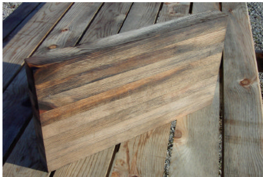
Panneaux contrecollés en Pin d'Alep type BMR (Bois Massif Reconstitué) ayant fait l'objet d'un traitement à l'huile
