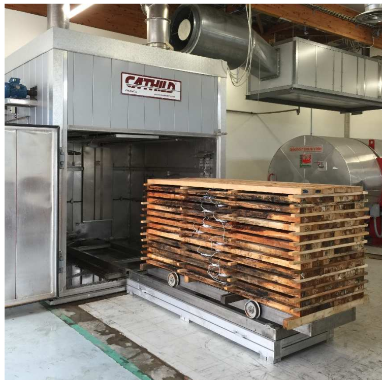
Photo 1 : Séchoir de laboratoire et charge de pin d'Alep
