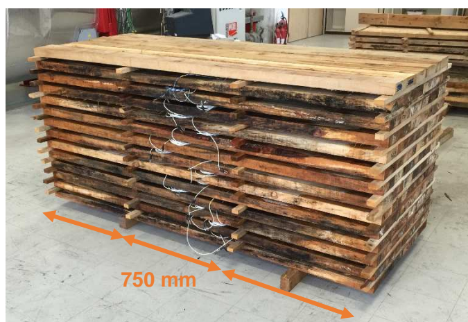
Photo 2: Pile de pin d'Alep avec baguettes (entraxe 750 mm)
