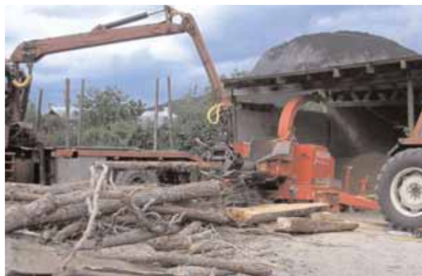
Des bois de qualité médiocre sont transformés en plaquettes. Celles-ci alimenteront tout au long de la saison de chauffe une chaudière desservant un réseau de chaleur de 6 logements.
