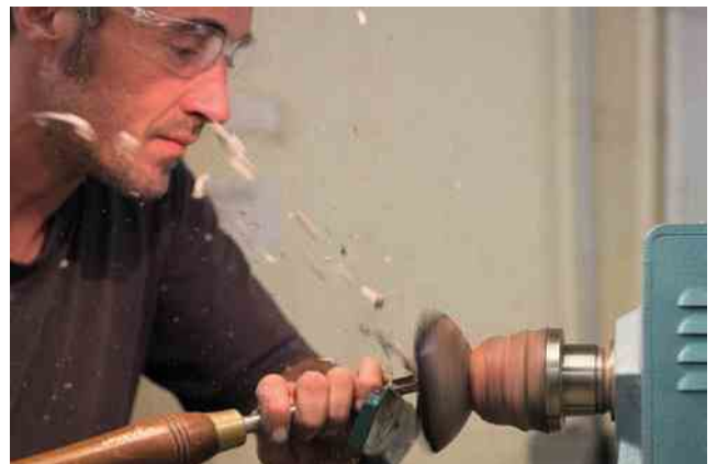
Yann Marot crée une coupe en arbusier à l'aide d'un mandrin qui maintient la pièce d'un seul côté. (S. Nalin, CRPF PACA)
