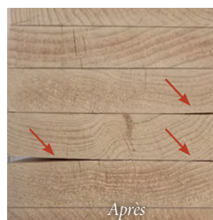
Echantillon avant et après les cycles d'imprégnation/séchage. Après l'essai, on observe de la délamination et des fissures sur les lamelles de bois
