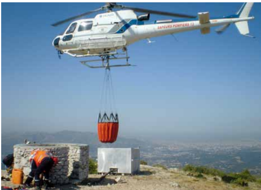
Remplissage du bac à eau en aluminium par l'hélicoptère bombardier d'eau.
