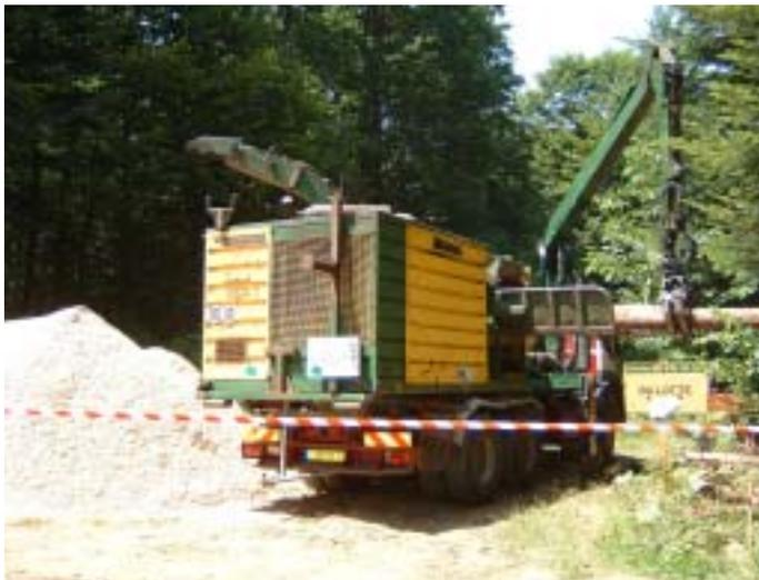
Ce matériel (*photo ci-contre*) permet un déchiquetage à la fois en forêt, suite à l'exploitation, pour une production de plaquettes vertes dans des bennes pour la livraison, ou une production directement dans des hangars de stockage (que le bois soit sec ou humide).
