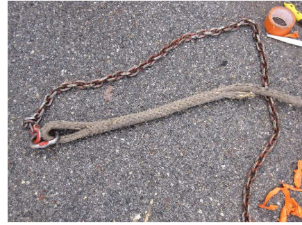
L'épissure ainsi réalisée est robuste. L'exploitant n'a pas constaté de cassure à ce niveau depuis le début de la saison.
