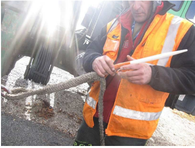
L'exploitant tire et fait ressortir complètement l'épissure. Il coupe le bout
