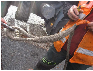
L'exploitant tire et fait ressortir complètement l'épissure. Il coupe le bout
