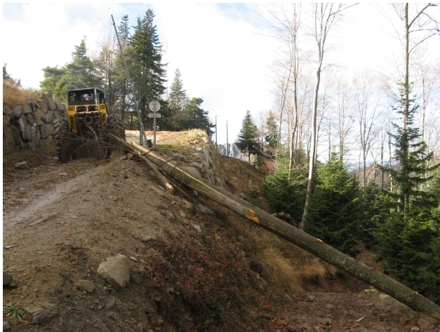
Exemple de débardage d'une grume fraîche de hêtre dont le poids est estimé à 1.5 tonnes. La limitation du poids débardé est, dans le cas de l'exploitant Bertrand, lié à la puissance de son tracteur.
