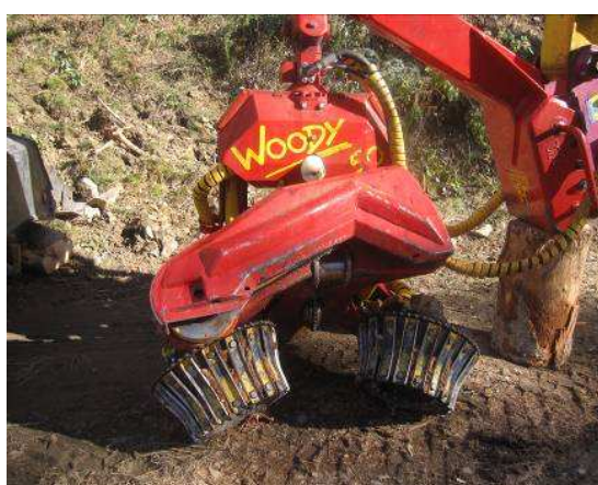
Tête d'abattage KONRAD WOODY 50 (capacité 55 cm en position ébranchage et 95 en position grappin (portage et manutention des bois))
