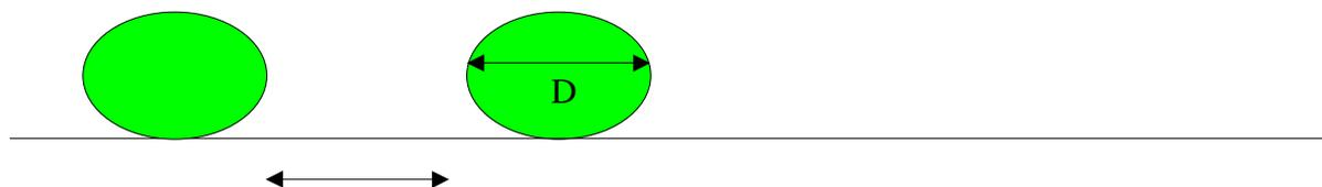
distance entre massifs  $\geq$  Diamètre
