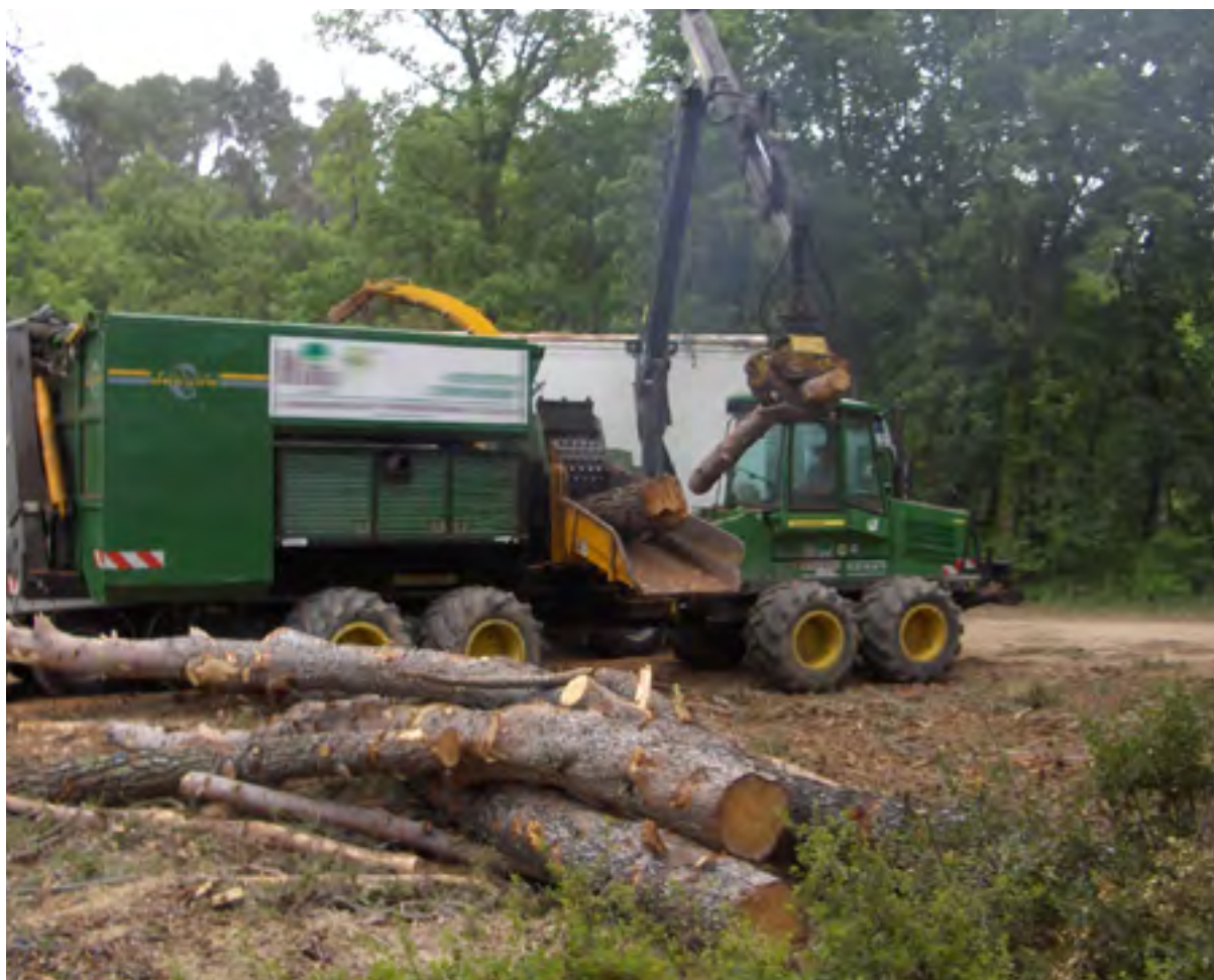
Broyeur à plaquettes mobile et camion de transport en espace boisé; Source : Service Forêt
