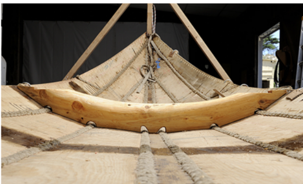
Varangue en pin d'Alep sur le navire construit dans le cadre du projet d'archéologie expérimentale « Protis » Photo L. Damelet, CCJ CNRS/AMU
