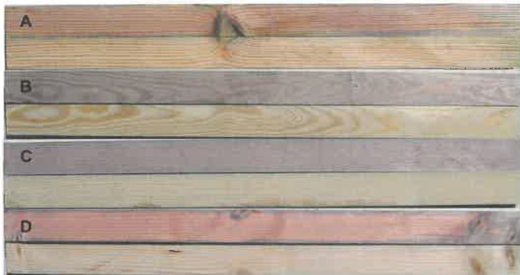
Photographie n°6: Epreuves après découpe dans le sens axial avant et après application du réactif
