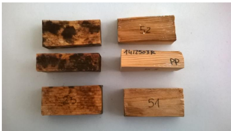
Figure 1 : Aspect des échantillons en fin d'essai après mise en présence avec le champignon Coniophora puteana (à gauche) et avec le champignon Poria placenta (à droite).
